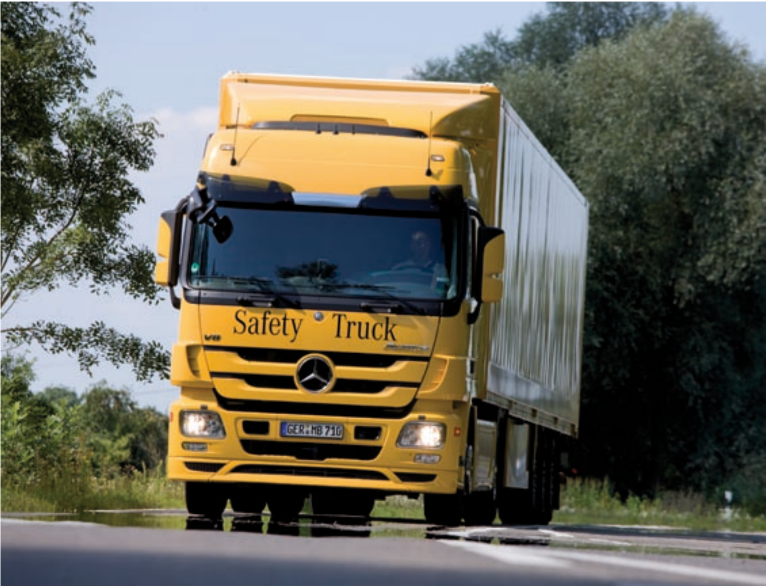
Lane Keeping Assist, Autonomous Intelligent Cruise Control, Active Brake Assist, and Stability Control are available for the Mercedes-Benz heavy-duty trucks. Spurassistent, Abstandsregeltempomat, Active Brake Assist und Stabilitätsregelung sind für die schweren Lkw von Mercedes-Benz lieferbar.
