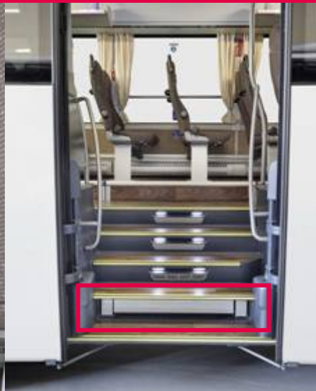
Dvižna ploščad za invalidske vozičke kot dodatna oprema.
